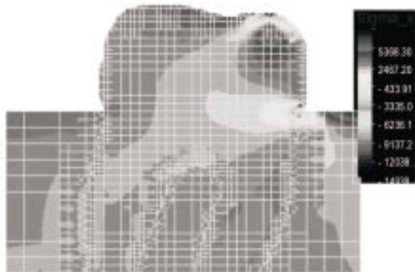
Рис. 2. Напряжения для модели здорового зуба при несимметричной вертикальной нагрузке в 30 кГ (пример проведения компьютерного эксперимента)
